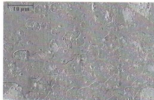
Figure 2: Localisation sélective des charges dans un composite PE/PA/ $\text{Bi}_2\text{Te}_{2.4}\text{Se}_{0.6}$
